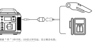
. 长按电源键" U " 3秒开机,LED显示屏亮起,显示剩余电量; . 短按DC控制开关按钮, 屏幕上DC指示灯亮: 3. 将您的设备/车载充电器线缆的标准5521mm线缆连接到本产品的5521mm端口。本品将为您的设备
