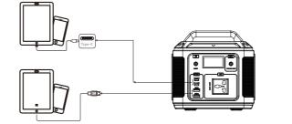
长按电源键"(I)"3秒开启设备,LED显示屏亮显示剩余电量; 2. 将数字设备的标配USB线连接到本产品的USB接口上,USB输出接口将为数字设备提供充电。这时屏幕 上的USB OUT/Type-C OUT指示灯亮起。
