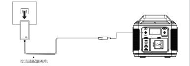
. 当屏幕上所有的电池电量图标都显示并且不再闪烁时,表示产品已充满电。请及时将充电适配器从交流 ※ 请使用指定的适配器给本产品充电。 ※ 请使用附带的适配器充电。
