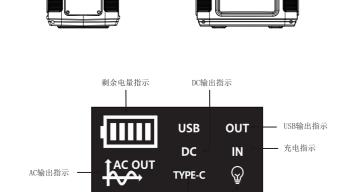
Type-C输入/输出指示 LED灯指示
